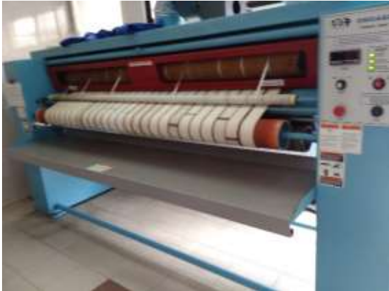
Foto N° 13. Plancha ubicada en el área de lavandería
